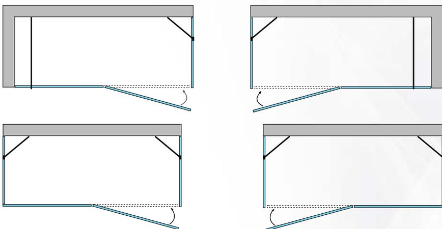
N.B. I braccetti stabilizzatori potrebbero essere aggiunti in caso di valutazione di poca stabilità del box su un solo muro.
